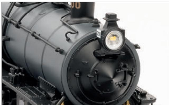
Neben dem Zweilicht-Spitzenignal ist das Notlicht an der Rauchkammertür separat digital schaltbar.
