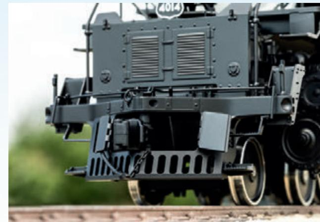
Die Frontkupplung ist raffiniert hinter zwei Klappen im Schienenrümer versteckt
