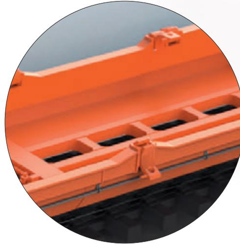
Vorbildgerecht mit je 4 Klappriegeln je Seite für den individuellen Wechsel zwischen 40ft., 20ft. oder Wechselbrücken
