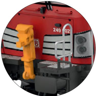
Der Vectron mit zusätzlicher Rangierbühne und Imitation der automatischen Rangierkupplung
