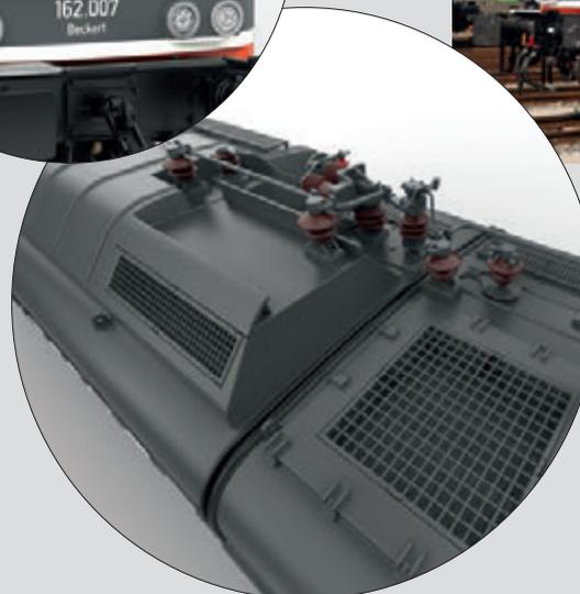
Dachaufbauten und Leitungsführung wie an der Hectorrail 162.007
