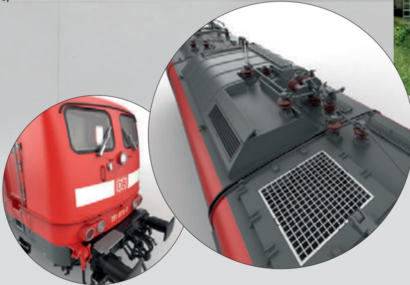
Die 151 070-0 im Modell mit abgesetztem Lüftungsgitter vorbildgerechter Leitungsführung, Trennschalter und langem Tritt an der Front
