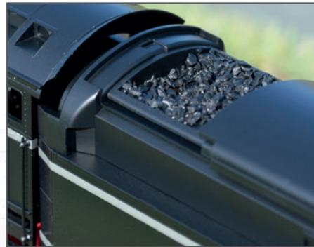
Abdeckung des Kohlenkastens kann geöffnet werden
