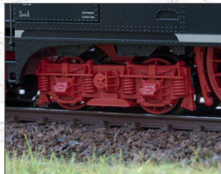
Indusi-Magnet auf der rechten Lokseite am hinteren Drehgestell
