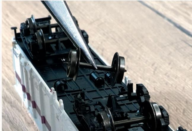
Als Hilfsmittel können ein Schraubendreher und eine Pinzette aus dem Werkzeugsatz 70900 dienen.
