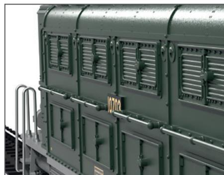
Wie beim Vorbild belegen acht Wartungskappen die Maschinenraumseite der Lokomotive. Gut zu sehen sind die für die Zeit charakteristisch schweren Verschlussriegel.
